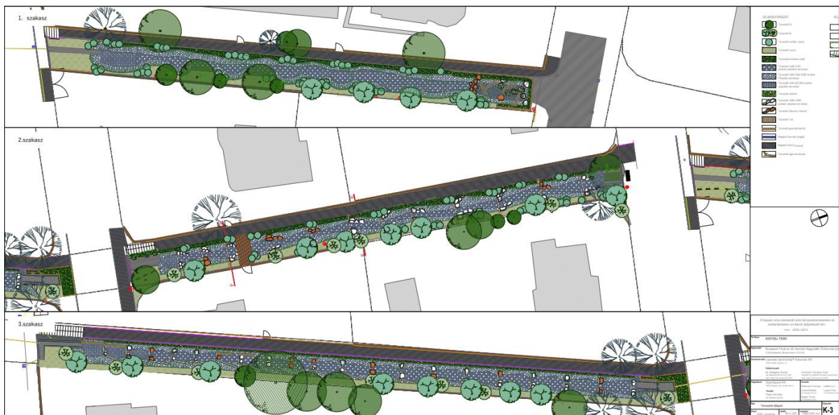
53. ábra: Szepesi utca vízvezető árok rekonstrukció – Kiviteli terv (Forrás: Hegyvidéki Zöld iroda, Készítette: Astrantia Kft)
