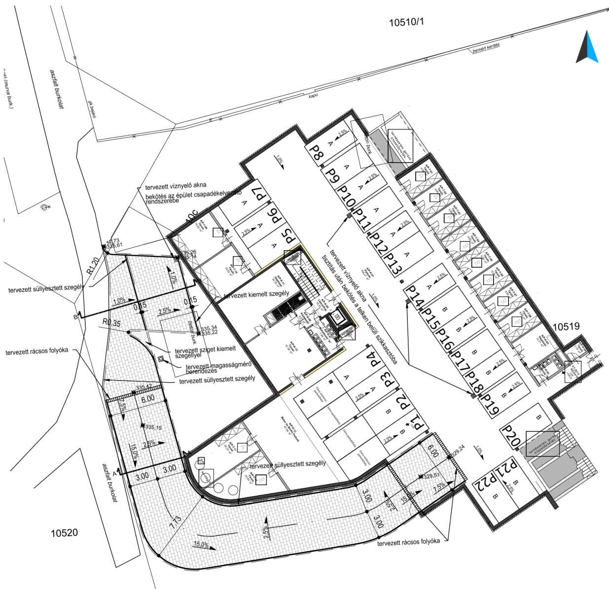
18. ábra: Tervezett mélygarázs és leejtő - Forrás Irtés Mémőiroda Kft terve
